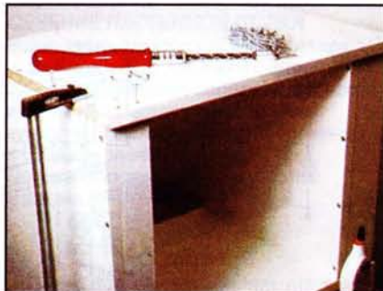
Детали выдвижного шкафчика склеивают и скрепляют шурупами.
