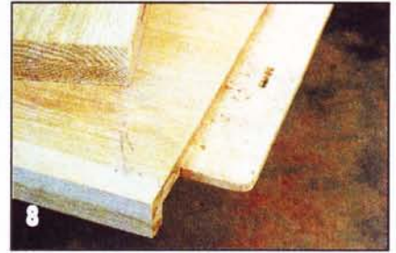
Сняв торцевые окантовки, распиливают крайние отверстия на шипах столешницы.
