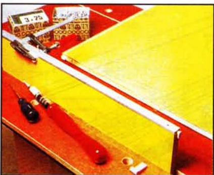
Тщательно зенкуют отверстия в уголках, чтобы головки шурупов не выступали.
