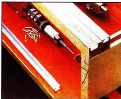
Под шурупы в деталях из древесины твёрдых пород предварительно сверлят отверстия.
