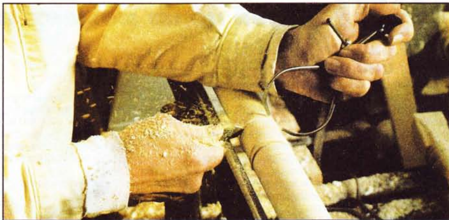
Сделать проточку в размер можно с помощью отрезного резца и кронциркуля.
